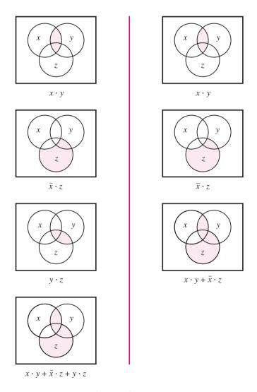
**Figure 2.16** Verification of  $x \cdot y + \overline{x} \cdot z + y \cdot z = x \cdot y + \overline{x} \cdot z$ .
